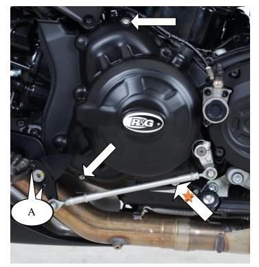
Le kit doit contenir : 1 x Protection carter moteur (ECC0215). 3 x M6 x45mm Boulons. 1 x M6 Rondelle 3x Entretoises (S0820).
